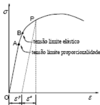
Figura 10: Gráfico tensão-deformação com descarregamento e carregamento.
